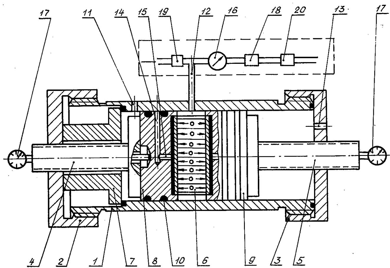
1 - цилиндр высокого давления; 2, 3 - крышки цилиндра; 4, 5 - регулируемые упоры; 6 - сотовый образец; 7 - втулка; 8, 9 - поршни; 10 - уплотняющие элементы; 11 - отверстие в цилиндре; 12 - канал для подвода давления; 13 - отверстие в крышке; 14, 15 - отверстия в поршне; 16 - манометр типа МТИ ГОСТ 2405-88; 17 - индикаторы часовые типа ИЧ-10 ГОСТ 577-68; 18 - редуктор; 19 - клапан для сброса давления; 20 - источник высокого давления
