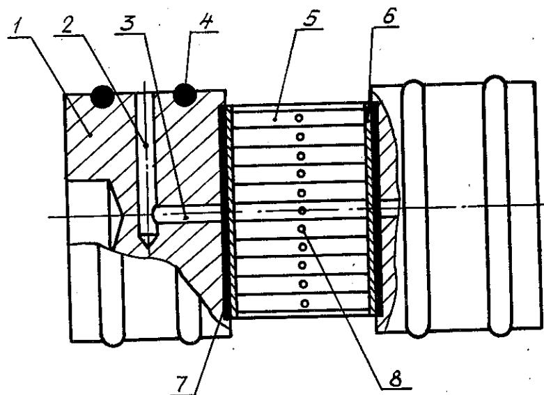
1 - поршень; 2, 3 - каналы для сброса давления;
